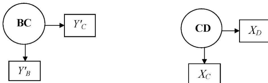
Рис. П.23. Возможные варианты первоочередного определения некоторых неизвестных сил реакций
