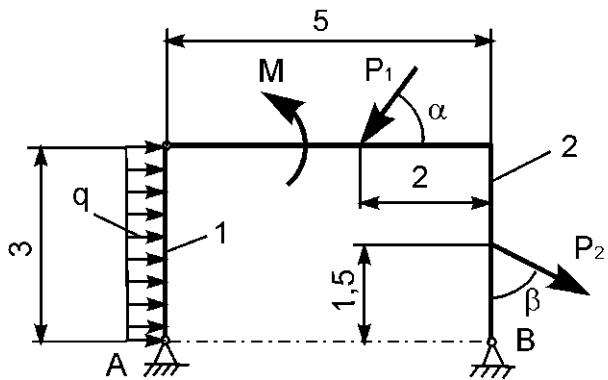
На плоскую механическую систему, состоящую из тел 1, 2, действуют активные нагрузки  $P_1$ ,  $P_2$ ,  $q$ ,  $M$ .
