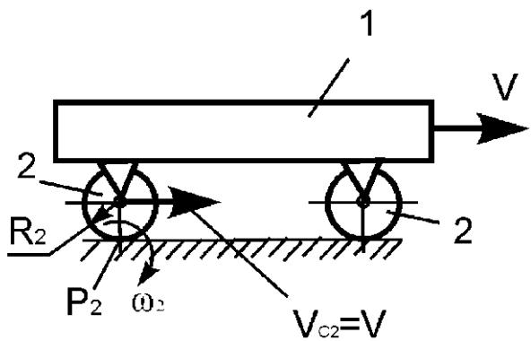
Тележка состоит из платформы 1 и колес 2. Платформа осуществляет поступательное движение со скоростью  $V$ .  $R_2$  – радиус колеса 2.  $J_{c2x2}$  – момент инерции колеса 2 относительно оси, проходящей через его центр масс.
