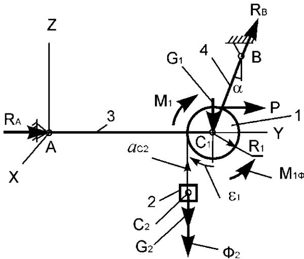
Механическая система, состоящая из однородного диска 1 с массой  $m_1$ , груза 2 массой  $m_2$ , невесомых стержней 3, 4 и нити, приходит в движение из состояния покоя. Р – активная сила;  $M_1$  – активный момент;  $R_1$  – радиус тела 1;  $J_{c1x1}$  – радиус инерции тела 1 относительно оси, проходящей через его центр масс.
