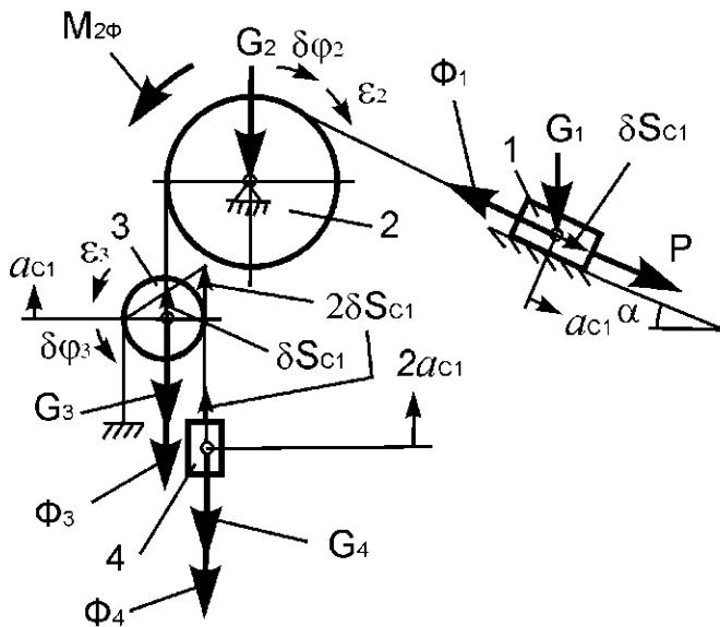
На механическую систему, состоящую из четырех тел, наложены идеальные связи. Известны геометрические параметры системы. Под действием активных нагрузок механическая система движется из состояния покоя.
