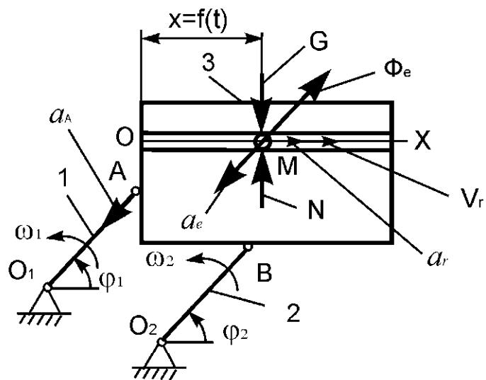
Плоский механизм состоит из трех тел. Тела 1, 2 имеют одинаковые размеры ( $O_1A = O_2B = r_1 = r_2 = r$ ) и совершают вращательные движения с постоянными угловыми скоростями  $\omega_1 = \omega_2 = \omega$ . По гладкому каналу, выполненному в теле 3, перемещается точка М массой  $m$ .
