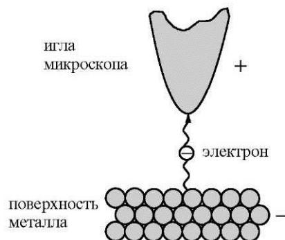
Рис. 1.2. Туннельный микроскоп. Туннельный ток зависит от расстояния между иглой и поверхностью.
