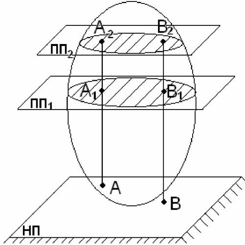
Большое распространение в технике имеет сложное движение твердого тела, называемое плоскопараллельным (или плоским) движением.
