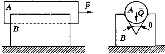
Каков должен быть угол  $\theta$ , чтобы движение началось при значении силы  $P$ , равной весу цилиндра  $Q$ ?
