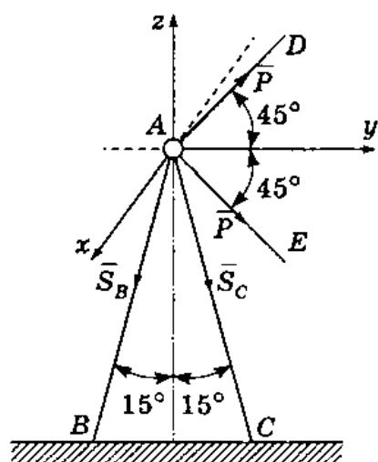
уравнения равновесия в проекциях на оси  $x$ ,  $y$  и  $z$ . Заметим, что первое уравнение (в проекциях на ось  $x$ ) имеет вид
