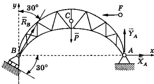
Составим уравнения равновесия фермы (в проекциях на оси  $x$  и  $y$  и для моментов сил относительно точки  $B$ ):
