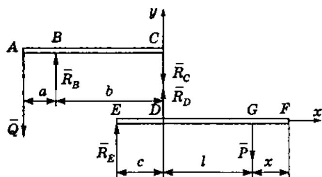
В данном случае исходную модель неравноплечих рычажных весов разобьем на части  $AC$ ,  $CD$ ,  $EF$  и запишем для каждой из них условия равновесия.
