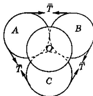
нижних. Определить натяжение шнура  $\bar{T}$ , вызываемое давлением верхнего шара. Трением шаров между собою и горизонтальной плоскостью пренебречь.
