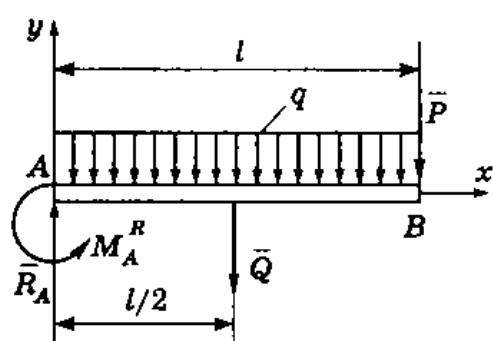
В жесткой заделке  $A$  возникает реактивная сила  $\bar{R}_A$  и реактивная пара сил  $M_A^R$ . Введем систему координат  $xAy$  и составим уравнения равновесия (для проекций на ось  $y$  и для моментов относительно точки  $A$ ):
