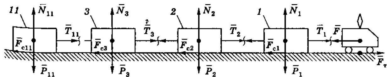
противления движению поезда;  $\bar{P}_i$  — вес  $i$ -го вагона;  $\bar{N}_i$  — реакция рельсов на  $i$ -й вагон;  $F_{ci}$  — сила сопротивления движению  $i$ -го вагона;  $T_i$  — сила натяжения стяжки  $i$ -го вагона.
