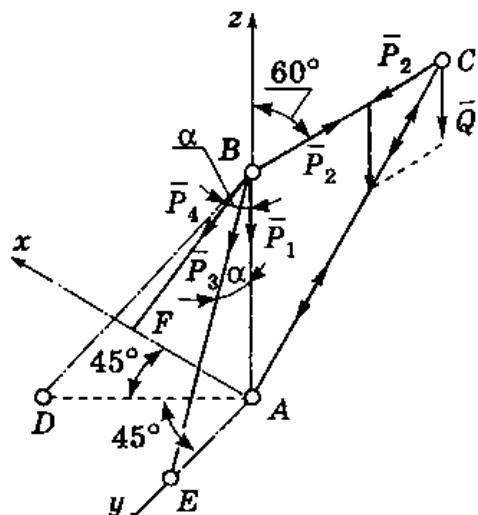
Затем рассмотрим равновесие узла  $B$ :
