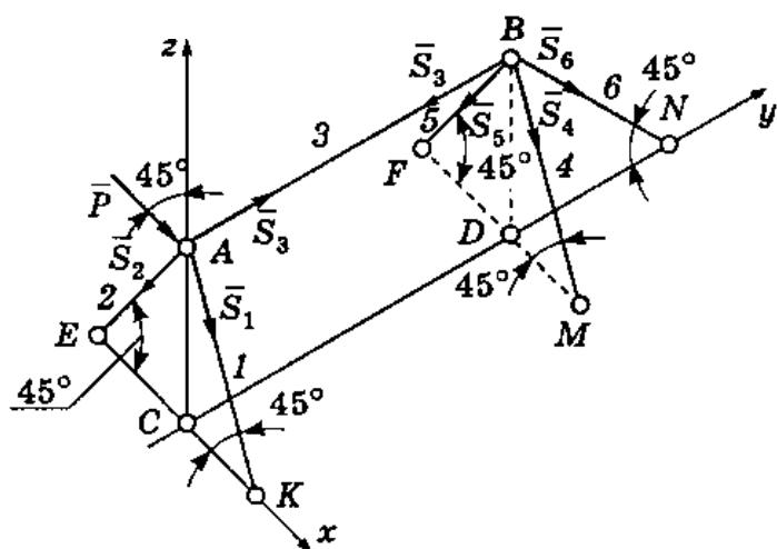
Сначала рассмотрим равновесие узла  $A$  (см. рисунок) и запишем уравнения равновесия (в проекциях на оси координат  $Ox$ ,  $Oy$  и  $Oz$  соответственно):
