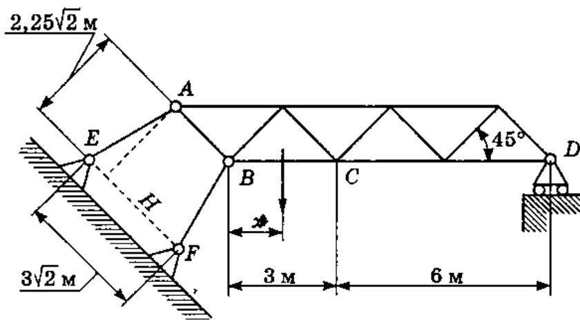
Вес фермы равен 25 кН и направлен по вертикали, проходящей через точку  $C$ . Вес нагрузки 112,5 кН. Определить, на каком расстоянии  $x$  от точки  $B$  нужно расположить нагрузку, чтобы реакция в опоре  $D$  стала равна нулю.
