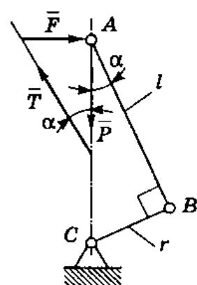
Сила давления газов равна:  $P = S(P_1 - P_2)$ , где  $S$  — площадь поршня.
