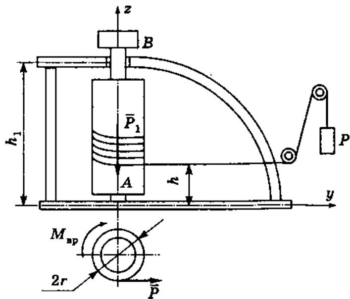
шипнике  $B$ . Вал приводится во вращение мотором. Найти необходимый для равномерного подъема копровой бабы вращающий момент мотора, а также реакции в под пятнике  $A$  и подшипнике  $B$ . При этом дано:  $h_1 = 1 \text{ м}$ ,  $h = 30 \text{ см}$  и вес вращающихся частей ворота  $P_1 = 1 \text{ кН}$ .
