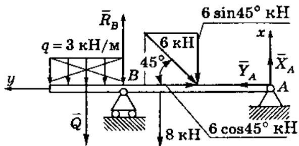
Составим уравнения равновесия (в проекциях на оси  $x$  и  $y$  и для моментов относительно точки  $A$ ):
