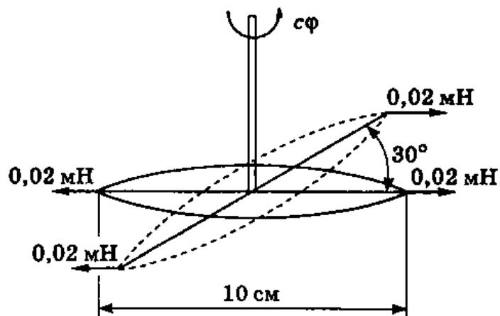
Момент возникающей от поворота стрелки на  $30^\circ$  пары сил магнитного поля равен
