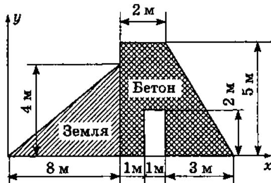
Здесь  $\gamma_1, S_1, x_1, y_1$  — соответственно плотность, площадь поперечного сечения, координаты центра тяжести земляной насыпи;  $\gamma_2, S_2, x_2, y_2$  — плотность, площадь поперечного сечения, координаты центра тяжести бетона.
