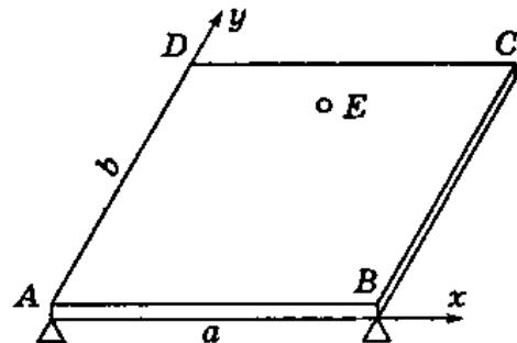
Изобразим на рисунке действующие на плиту активные силы и реакции связей и для полученной системы параллельных сил
