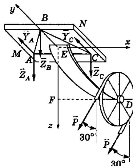
$$\begin{cases} Y_A + Y_C + 2P \sin 30^\circ = 0, \\ Z_A + Z_B + Z_C + 2P \cos 30^\circ = 0, \\ -Z_A \cdot \frac{1}{3} \cdot 30 \sin 60^\circ - Z_C \cdot \frac{1}{3} \cdot 30 \sin 60^\circ + \\ + Z_B \cdot \frac{2}{3} \cdot 30 \sin 60^\circ - 2P \sin 30^\circ \cdot EF = 0, \\ Z_A \cdot 15 - Z_C \cdot 15 - 2P \cos 30^\circ \cdot FD = 0, \\ Y_C \cdot 15 - Y_A \cdot 15 + 2P \sin 30^\circ \cdot FD = 0. \end{cases}$$
