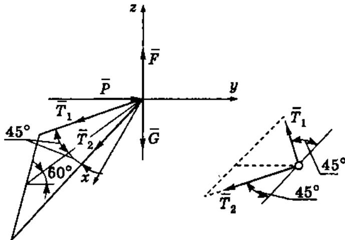
На шар, кроме силы тяжести  $\bar{G}$ , натяжений тросов  $\bar{T}_1$ ,  $\bar{T}_2$ , силы ветра  $\bar{P}$ , действует подъемная сила  $F = 215,4 \cdot 13 = 2800,2$  Н (см. рисунок). Составим уравнения равновесия пространственной сходящейся системы сил (в проекциях на оси координат):
