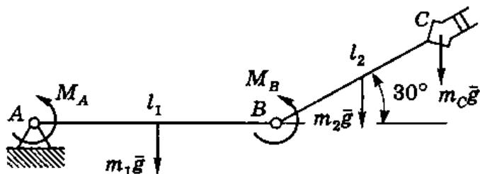
Составим сумму моментов внешних сил относительно точки *B* и приравняем ее к нулю:
