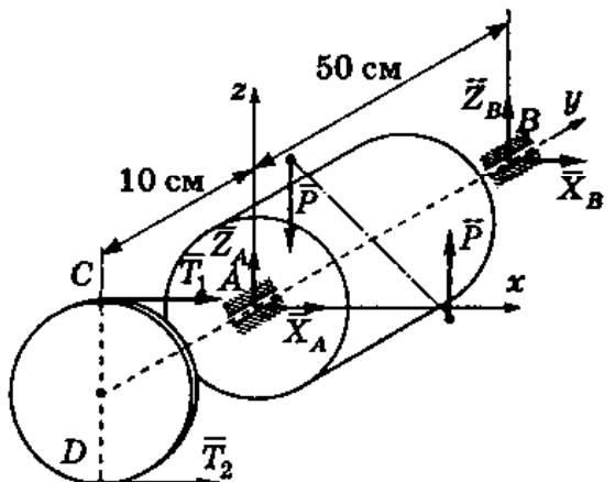
$$\begin{cases} X_A + X_B + T_1 + T_2 = 0, \\ 0 = 0 \text{ (выполняется тождественно)}, \\ Z_A + Z_B = 0, \\ Z_B \cdot 0,5 = 0, \\ T_1 \cdot 0,1 - T_2 \cdot 0,1 - M = 0, \\ -X_B \cdot 0,5 + T_1 \cdot 0,1 + T_2 \cdot 0,1 = 0. \end{cases}$$
