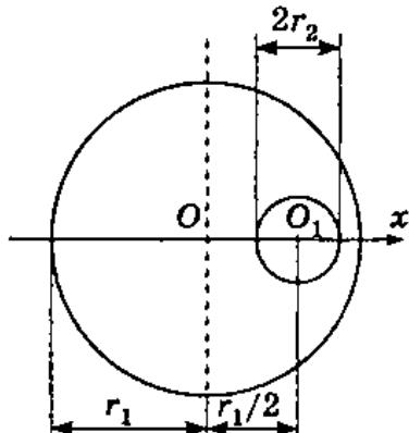
тельно, центр тяжести будет располагаться на этой оси. Обозначим диск без выреза фигуруй 1 площадью  $S_1$  и с центром тяжести  $C_1 = O$ , отверстие — фигуруй 2 площадью  $S_2$  и с центром тяжести  $C_2 = O_1$ . Тогда получим
