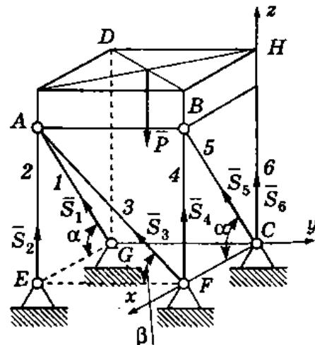
$$\begin{cases} -S_1 \cos \alpha + S_5 \cos \alpha = 0, \\ -S_3 \cos \beta = 0, \\ S_2 + S_4 + S_6 + S_1 \sin \alpha + S_5 \sin \alpha + S_3 \sin \beta - P = 0, \\ -S_2 \cdot EF - S_1 \sin \alpha \cdot EF + P \frac{AB}{2} = 0, \\ -S_2 \cdot GE - S_3 \sin \beta \cdot CF + P \frac{BH}{2} = 0, \\ S_1 \cos \alpha \cdot GC - S_3 \cos \beta \cdot CF = 0. \end{cases}$$
