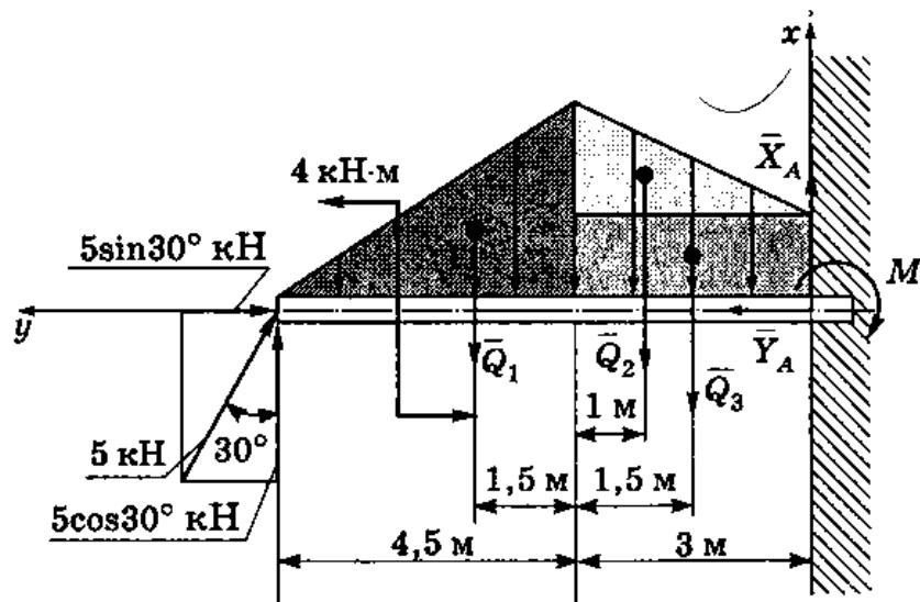
Составим уравнения равновесия (в проекциях на оси  $x$  и  $y$  и для моментов относительно точки  $A$ ):
