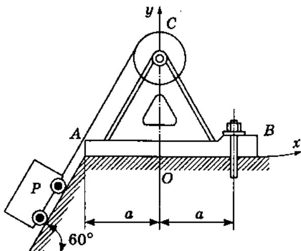
ся в точке  $A$  на гладкий пол, а в точке  $B$  прикреплена к полу болтом. Найти опорные реакции, пренебрегая расстоянием веревки от плоскости.
