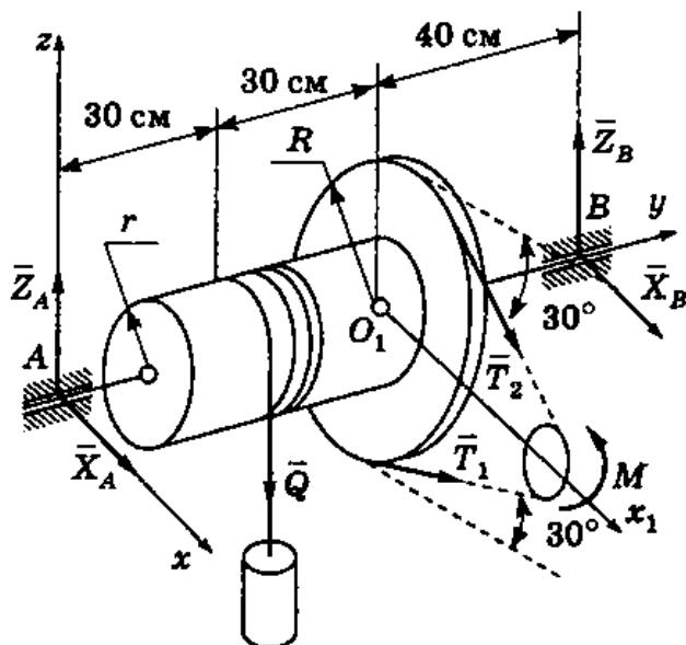
$$Z_B = 0,3 \cdot Q + (T_2 - T_1) \sin 30^\circ \cdot 0,6 = 3 - 5 \cdot 0,3 = 1,5 \text{ кН};$$
