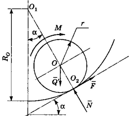
В положении равновесия плоскость, проходящая через оси цилиндра  $AB$  и блока, образует с вертикалью угол, равный углу трения.
