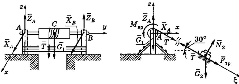
Теперь в качестве объекта равновесия рассмотрим ворот  $AB$ . Так как он вращается равномерно, то действующие на него силы также взаимно уравновешены, и мы получим (уравнения равновесия в проекциях на оси  $x$ ,  $z$  и для моментов относительно  $x$ ,  $y$ ,  $z$ ):
