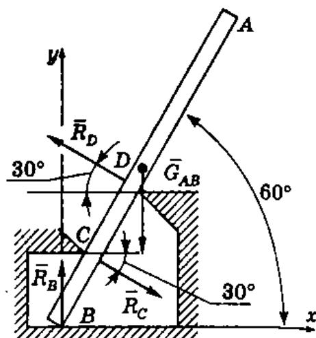
Из первого уравнения системы следует  $R_C = R_D$ , поэтому из второго уравнения системы получим
