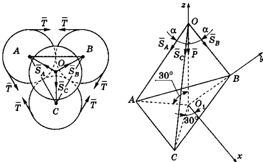
Центры шаров  $A, B, C, O$  образуют правильный тетраэдр со стороной  $2R$ , где  $R$  — радиус шара. На три нижних шара со стороны верхнего действуют усилия  $\bar{S}_A, \bar{S}_B, \bar{S}_C$  от силы тяжести  $\bar{P}$  (см. рисунок).
