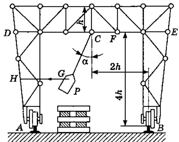
во избежание колебаний груза он оттягивается горизонтальным канатом  $GH$ . Предполагая, что горизонтальная составляющая натяжения цепи воспринимается одним правым рельсом  $B$ , определить усилие  $S_1$  в горизонтальном стержне  $CF$  в момент отделения груза от подмостей и сравнить его с тем усилием  $S_2$ , которое получилось бы при угле  $\alpha = 0^\circ$ . Размеры указаны на рисунке.
