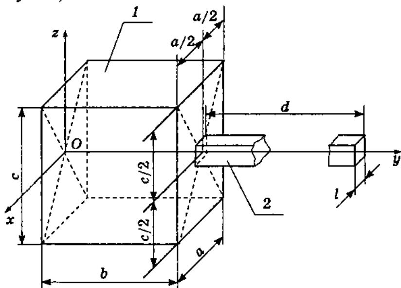
Тогда на основе исходных данных определим объемы  $V_1$  и  $V_2$  этих тел и координаты их центров тяжести  $(x_1, y_1, z_1)$  и  $(x_2, y_2, z_2)$ :
