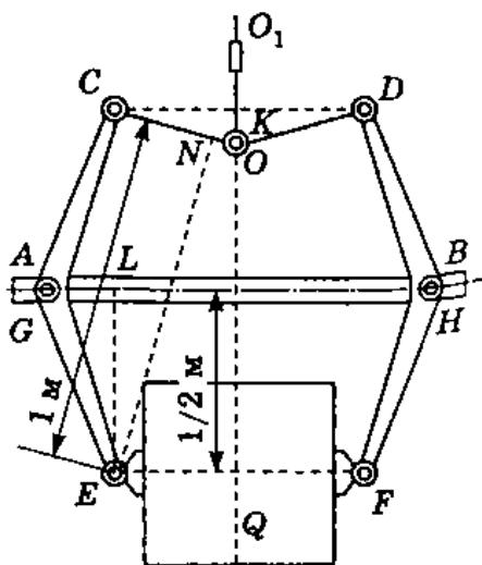
от стержня  $OC$  равно  $EN = 1$  м. Высота треугольника  $COD$  равна  $OK = 10$  см. Найти силу, растягивающую соединительный стержень  $GH$ , пренебрегая весом частей механизма.
