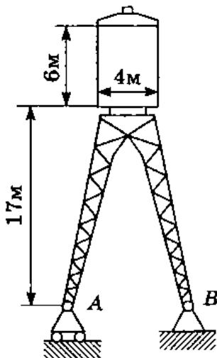
Определить необходимое расстояние  $AB$  между основаниями столбов. (Расстояние  $AB$  должно быть рассчитано на опрокидывание давлением ветра при горизонтальном его направлении.)
