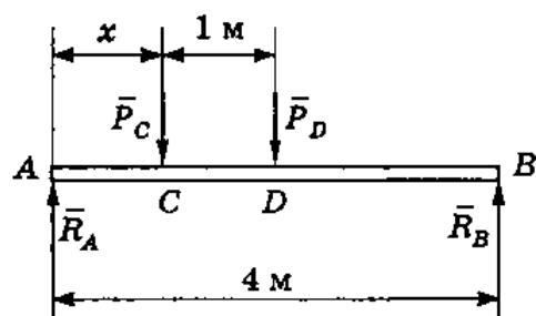
циями). Условия равновесия полученной параллельной системы сил запишем для моментов всех сил относительно точек  $A$  и  $B$ :
