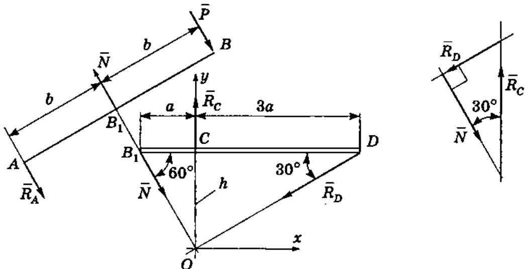
Рассмотрим равновесие балки  $B_1D$ . Силы, приложенные к балке  $B_1D$ , образуют систему сходящихся сил. Условия равновесия системы сходящихся сил:
