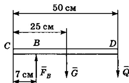
Открытие клапана соответствует повороту рычага  $CD$  в направлении против часовой стрелки. Это означает тот факт, что момент силы  $F_B$  относительно шарнира  $C$  по крайней мере равен
