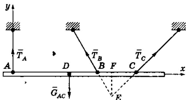
Составим уравнения равновесия балки (для проекций сил на оси  $x$  и  $y$  и для моментов относительно точки  $E$ ):
