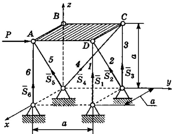
$$\begin{cases} S_5 \cos 45^\circ + S_2 \cos 45^\circ = 0, \\ P + S_4 \cos 45^\circ = 0, \\ S_6 + S_1 + S_3 + S_5 \cos 45^\circ + S_4 \cos 45^\circ + S_2 \cos 45^\circ = 0, \\ Pa + S_1 a + S_3 a + S_2 \cos 45^\circ a = 0, \\ -S_1 a - S_6 a = 0, \\ Pa + S_2 a \cos 45^\circ = 0. \end{cases}$$
