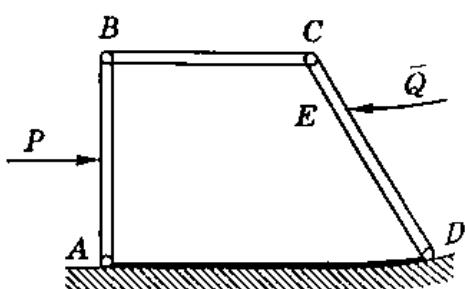
если  $CE = CD/4$ , чтобы механизм был в равновесии? Найти реакцию в шарнире  $D$ . Весом звеньев пренебречь.
