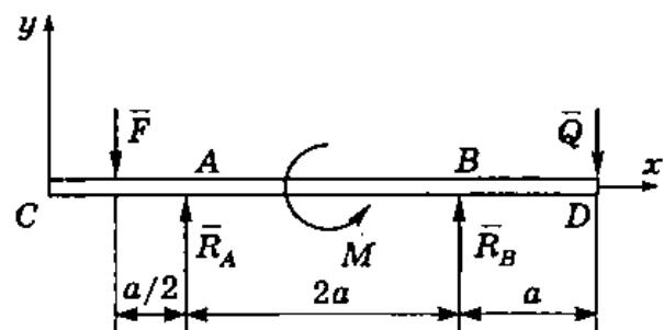
балку против часовой стрелки. Заменив связи их реакциями, в результате получим плоскую параллельную систему сил.
