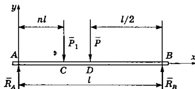
В системе координат  $xAy$  запишем уравнения равновесия для моментов всех сил относительно точки  $A$  и проекций сил на ось  $y$ :
