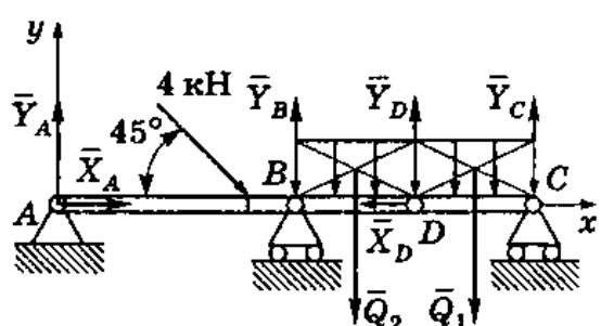
Второй объект равновесия — часть балки  $ABD$ . Поменяв реакцию в шарнире  $D$  на противоположную:  $Y'_D$  (т.е.  $\bar{Y}'_D = -\bar{Y}_D$ ), составим уравнения равновесия (в проекциях на оси  $x$  и  $y$  и для моментов относительно точки  $A$ ):
