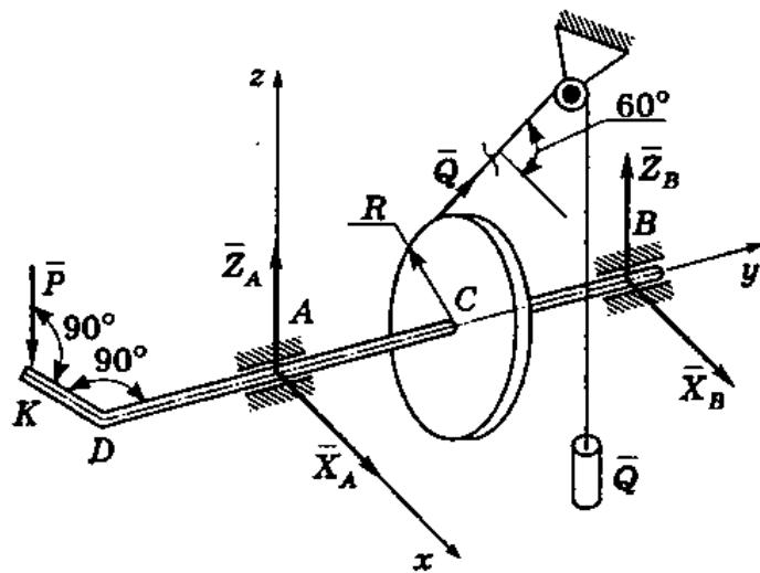
Для данной системы сил составим уравнения равновесия (в проекциях на оси  $x$ ,  $z$  и для моментов относительно осей  $x$ ,  $y$ ,  $z$ ):
