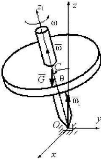
Твёрдое тело веса  $G = 40$  (н), являющееся гироскопом, вращается вокруг оси  $Oz_1$ , проходящей вокруг центра масс  $C$  и неподвижную точку  $O$ , с угловой скоростью  $\omega = 500$  ( $\text{с}^{-1}$ ). Тело отклонено от вертикали на угол  $\theta = 45^\circ$ , угловая скорость прецессии равна  $\omega_1 = 0,6$  ( $\text{с}^{-1}$ ), расстояние  $OC = 30$  (см). Момент инерции относительно оси симметрии  $Oz_1$  будет равен  $J = \dots$  ( $\text{кг}\cdot\text{м}^2$ )
