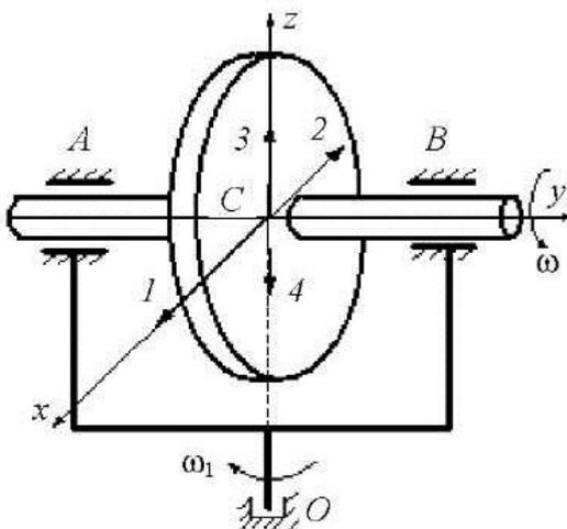
Массивный ротор вращается в подшипниках  $A$  и  $B$  с угловой скоростью  $\omega$  вокруг оси  $Cy$ , являющейся осью симметрии и проходящей через центр масс  $C$ . Вся система поворачивается вокруг оси  $Oz$ , также проходящей через центр масс, с угловой скоростью  $\omega_1$ . Запишите номер направления, по которому будет направлен момент дополнительных гироскопических реакций подшипников  $A$  и  $B$ :  $\bar{M}_C(\bar{R}_A, \bar{R}_B)$
