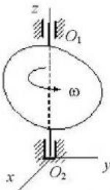
Тело равномерно вращается вокруг оси  $z$  с угловой скоростью  $\omega = 5 \text{ с}^{-1}$ . За время  $t = 0,8$  с тело повернётся на угол ...
