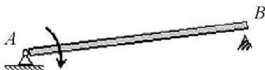
Стержень  $AB$  длиной  $0,2$  м вращается с угловой скоростью  $2$  рад/с вокруг оси шарнира  $A$ . Момент инерции стержня относительно оси вращения равен  $8$  кг·м<sup>2</sup>. После удара концом  $B$  о неподвижное препятствие стержень останавливается. Импульс ударной реакции равен ...
