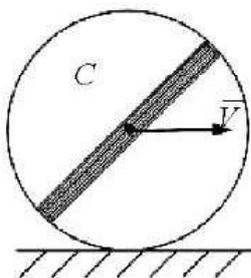
Диск радиусом  $R$  и массой  $m$ , которая равномерно распределена по тонкому стержню, проходящему через центр, катится по горизонтальной плоскости без, имея в точке  $C$  скорость  $\bar{V}$ .
