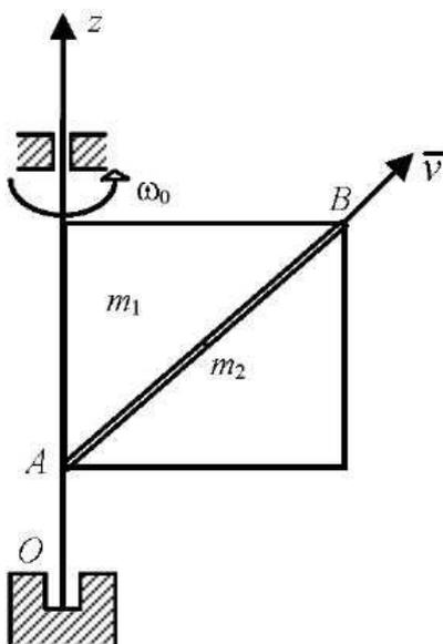
Однородная квадратная пластина, имеющая массу  $m_1$ , вращается с угловой скоростью  $\omega_0$  вокруг неподвижной оси  $Oz$ , совпадающей с одной из сторон пластины. В середине жёлоба  $AB$  находится материальная точка с массой  $m_2$ . В случае сохранения кинетического момента системы, угловая скорость пластины, в момент вылета материальной точки из жёлоба в положении  $B$ , равна ...
