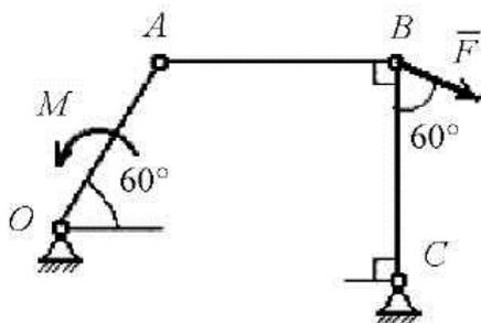
Механизм, изображённый на чертеже, находится в равновесии под действием силы  $F$  и момента  $M$ ,  $OA = r$ ,  $BC = a$ .
