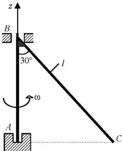
К валу  $AB$  жёстко прикреплен стержень  $BC$  с массой  $2$  кг. Вал вращается вокруг своей оси  $Az$  с постоянной угловой скоростью  $\omega = 5$  рад/с. Длина стержня  $BC = l = 0,6$  м. Модуль динамической реакции подшипника  $B$  равен ... (Н)
