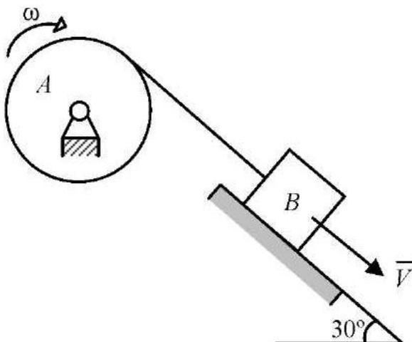
Механическая система состоит из блока  $A$ , на который накручен нерастяжимый трос, и груза  $B$  массой  $4$  кг, присоединённого к тросу. Кинетическая энергия системы в начальном положении равна  $2$  Дж. После перемещения груза вдоль наклонной плоскости на величину  $S$  кинетическая энергия системы увеличивается до  $4$  Дж. Принять  $g = 10$  м/с<sup>2</sup>.
