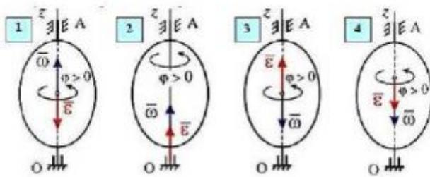
Твёрдое тело вращается вокруг неподвижной оси  $Oz$  согласно уравнению  $\varphi = 2t^3 - 10t$ , где  $\varphi$  – угол поворота в радианах. В момент  $t = 2$  с угловая скорость и угловое ускорение будут направлены, как показаны на рисунке ...
