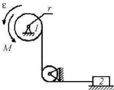
Угловое ускорение барабана  $1$   $\varepsilon = 10$  с<sup>-1</sup>, массы тел  $m_1 = m_2 = 2$  кг, радиус барабана  $1$ , который можно считать однородным цилиндром,  $r = 0,2$  м, ( $g = 10$  м/с<sup>2</sup>, трением пренебречь). Тогда модуль момента  $M$  пары сил равен ...
