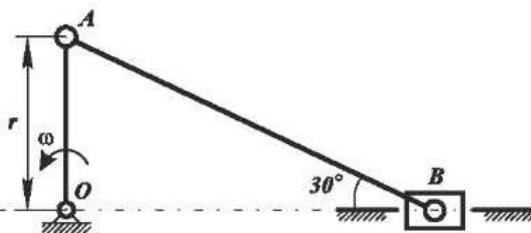
В кривошипно-шатунном механизме кривошип  $OA$  длиной  $r$  вращается с постоянной угловой скоростью  $\omega$ .
