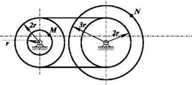
Точка  $M$  одного из колес цепной передачи имеет скорость  $V_M = 0,3$  м/с. Скорость точки  $N$  другого колеса равна ... (м/с)
