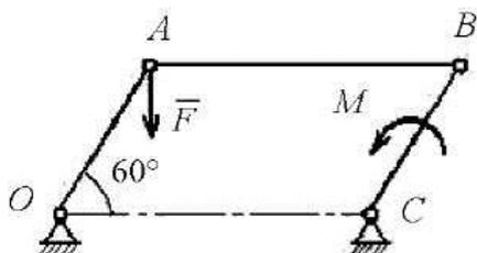
Механизм, изображённый на чертеже, находится в равновесии под действием силы  $F$  и момента  $M$ ,  $OA = BC = r$ ,  $AB = a$ .
