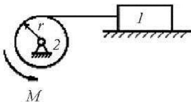
Тело  $1$  массой  $m_1 = 20$  кг движется с постоянным ускорением  $a = 1$  м/с<sup>2</sup>, момент инерции барабана относительно оси вращения  $I_2 = 12$  кг·м<sup>2</sup>, радиус  $r = 0,3$  м ( $g = 10$  м/с<sup>2</sup>, трением пренебречь). Тогда модуль момента пары сил равен ...
