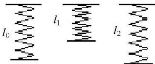
Если  $c$  – жёсткость пружины,  $c = 400$  Н/м;  $l_0$  – длина ненапряжённой пружины,  $l_0 = 50$  см;  $l_1$  – начальная длина пружины,  $l_1 = 30$  см;  $l_2$  – конечная длина пружины,  $l_2 = 40$  см, то работа, совершаемая силой упругости пружины при изменении длины от значения  $l_1$  до значения  $l_2$ , равна ...
