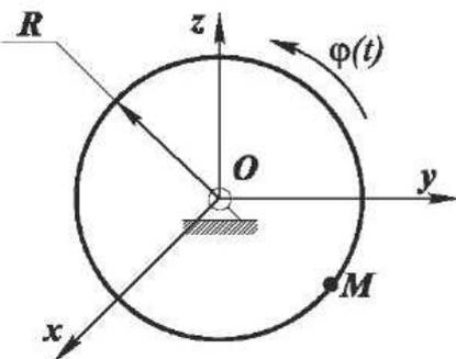
Диск радиуса  $R = 0,5$  м вращается вокруг неподвижной оси  $Oz$ , перпендикулярной его плоскости, по закону  $\varphi = 2t^3 + 3t^2$  рад. Нормальное ускорение точки  $M$  в момент времени  $t = 1$  с равно ... ( $\text{м/с}^2$ ).
