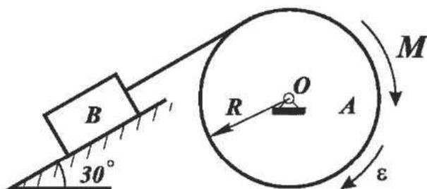
Механическая система состоит из блока  $A$ , на который накручен трос, и груза  $B$  массой  $1$  кг, присоединённого к тросу. Блок радиуса  $R = 0,5$  м вращается под действием пары сил с моментом  $M$  с угловым ускорением  $\epsilon = 3$  рад/с<sup>2</sup>. Массой блока пренебречь. Принять  $g = 10$  м/с<sup>2</sup>. Модуль реакции шарнира  $O$  равен ... (Н)
