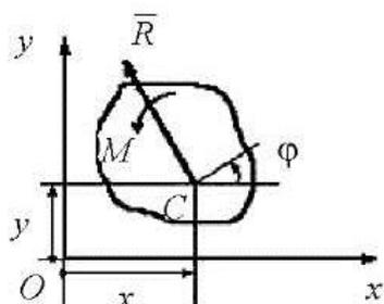
Плоская система сил, действующая на тело, приведена к главному вектору  $\bar{R} = 3\bar{i} - 6\bar{j}$  и главному моменту  $M = 10$  Нм ( $\bar{r} = \overline{OC} = 4\bar{i} - 3\bar{j}$  – в данный момент).
