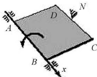
Вращаясь вокруг оси  $Ax$  с угловой скоростью  $6$  рад/с, квадратная пластина  $ABCD$  наталкивается на неподвижное препятствие в точке  $N$  и после удара останавливается. Момент инерции пластины относительно оси вращения  $Ax$  равен  $10$  кг·м<sup>2</sup>, длина стороны  $AB = BC = 0,6$  м. Импульс ударной реакции в точке  $N$  равен ...
