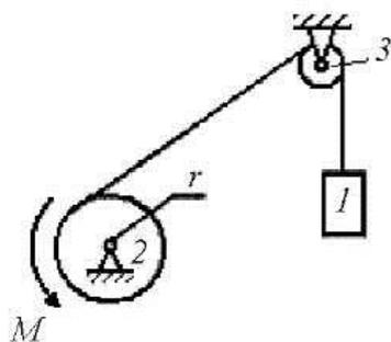
Тело  $1$  поднимается с ускорением  $a = 2$  м/с<sup>2</sup>, массы тел  $m_1 = m_2 = 50$  кг,  $m_3 = 10$  кг, радиус барабана  $2$ , который можно считать однородным цилиндром,  $r = 0,5$  м, блок  $3$  можно считать однородным цилиндром ( $g = 10$  м/с<sup>2</sup>). Тогда модуль момента пары сил равен ...
